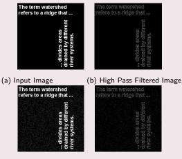
(c) Input Noisy Image (d) High Pass Filtered Noisy Image
